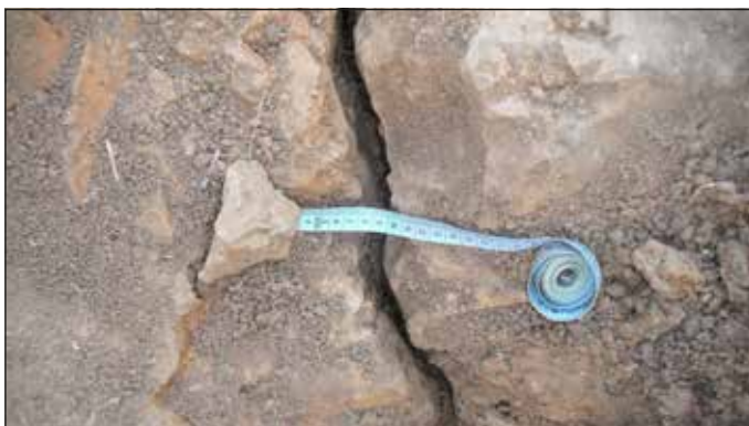
Obr. 5 Hrúbka puklín dosahuje obvykle 2 cm, zriedka, najmä v miestach rozvetvenia puklín 3 cm, profil 1, Nitrianske Hrnčiarovce
