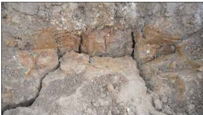
Obr. 4 Výrazné pukliny, typické pre vertikálne pôdy v suchom období roka, profil 1, Nitrianske Hrnčiarovce
