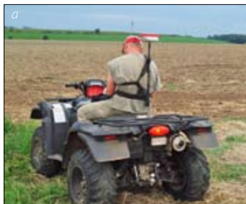
Obr. 1 Zber pozemných údajov nadmorskej výšky v kinematickom móde prostredníctvom technológie GNSS a) s využitím štvorkolky b) výsledné vstupné bodové pole záujmového územia
