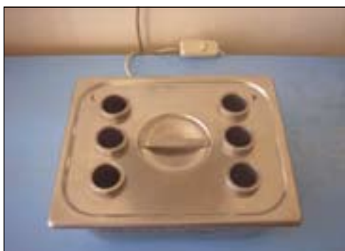
Obr. 4 Pôdna osievačka - prístroj na mokré preosievanie agregátov
