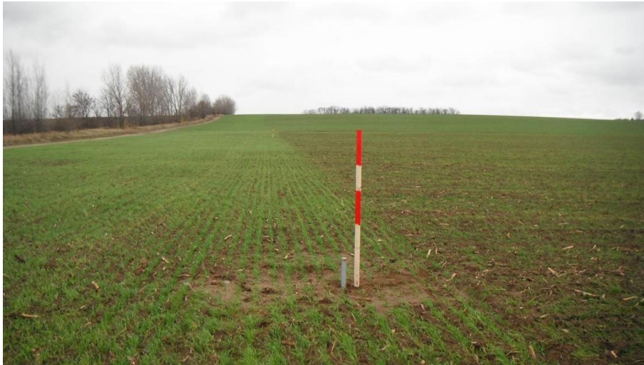
Obrázok 7 Trvalé monitorovacie miesto R12 so zavedenou kovovou výpažnicou pre vlhkosťnú sondu. V pozadí je viditeľné aj monitorovacie miesto R11 (autor fotografie: Rastislav Dodok).
