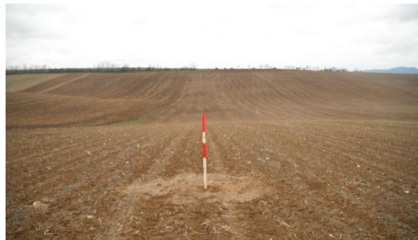
Obrázok 8 Trvalé monitorovacie miesto R31 (a) so zavedenou kovovou výpažnicou pre vlhkosťnú sondu umiestnený na vrcholovej plošine sprašovej tabule a monitorovacie miesto R32 (b) umiestnené na svahu úvaliny. Monitorovacie miesto R33 umiestnené na dne úvaliny (b) nie je označené (autor fotografií: Rastislav Dodok).
