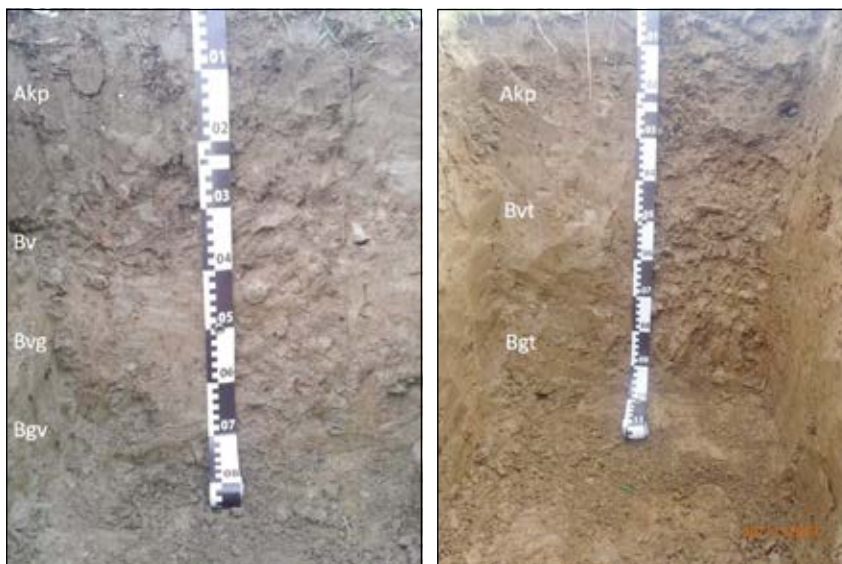
Obř. 5 Ukážka pôdnych profilov kambických pôd v bývalom VO Javorina Kambizem pseudoglejová kultizemná Kambizem luvizemná pseudoglejová kultizemná
